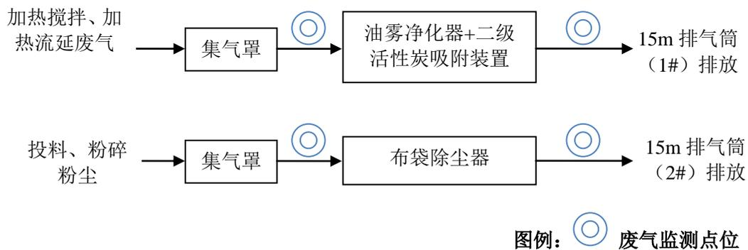
图 3-2 有组织废气处理流程图及监测点位
