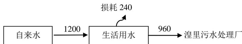
图 2-1 验收项目水平衡图 (t/a)
