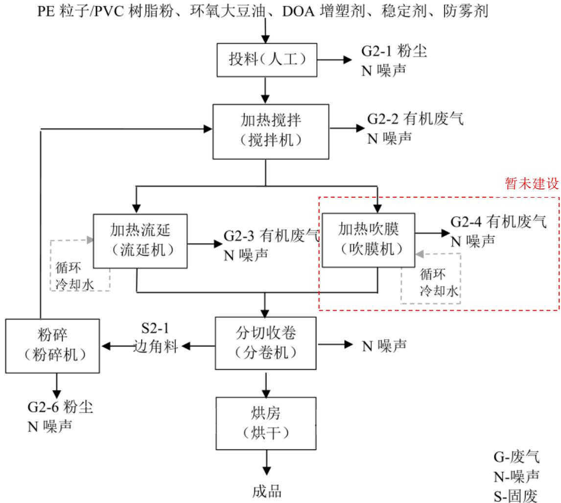
图 2-2 塑料保鲜膜工艺流程图
